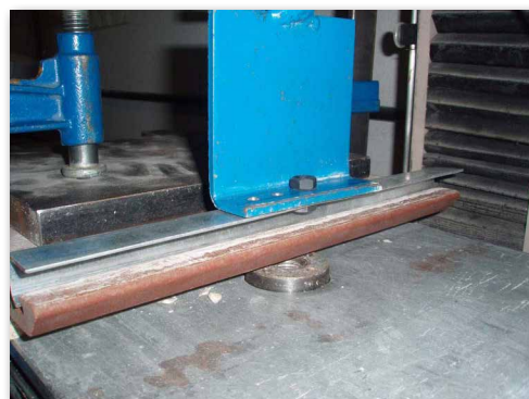
Figura 3: Ensayo de resistencia de la ranura del revestimiento
