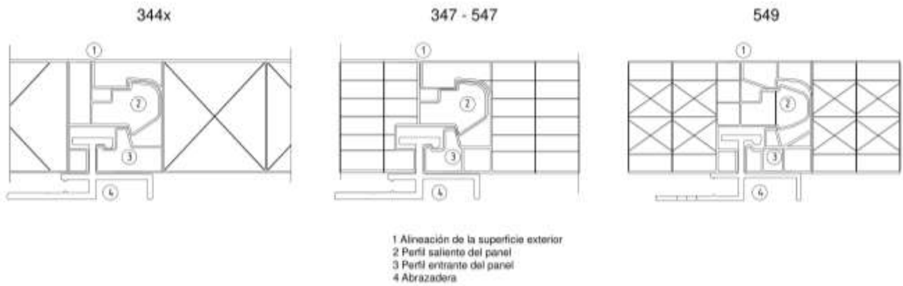
Figura 5.1: Detalle del encastre entre paneles.
