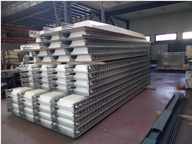
Figura 4.1: Apilament de prelloses del sistema SES™.
