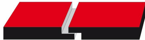
Figura 4.1: Junta con galce.
