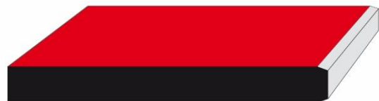
Figura 2.2: Panel con cantos biselados.
