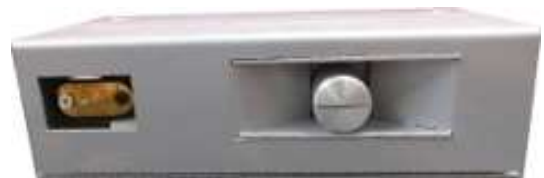
Figura 2.3: Cajón metálico con el fusible y la boquilla de extinción.
