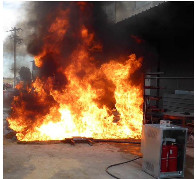
Figura 9.1: Ensayos de extinción (hogar de 3 m x 4 m) del sistema Petroex con circuito de accionamiento mecánico.
