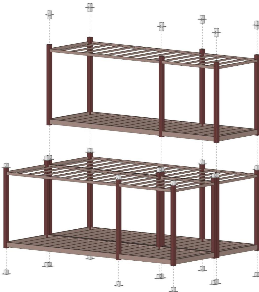
Figura A1.1: Unidades SEH®, componentes y piezas de conexión.
