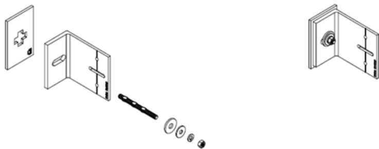
Figura A4.20a: Pieza de rotura del puente térmico. Termostop 100.
