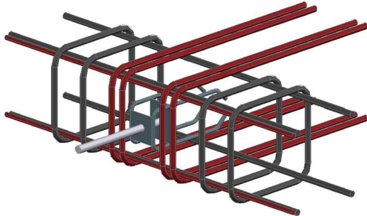
Figura 5.3: Disposición de los estribos de la armadura de suspensión y armadura de la viga de borde. Vista tridimensional.
